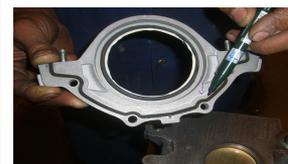
9) O uso de cola é necessário na região compreendida entre a carcaça do retentor e o bloco do motor, nesta face já existe uma nervura construída com o próprio elastômero (borracha) do retentor, o que é ideal para uma perfeita vedação estática.
